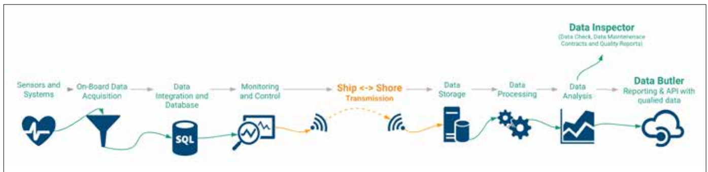
Aufbau des „Data Highways“
